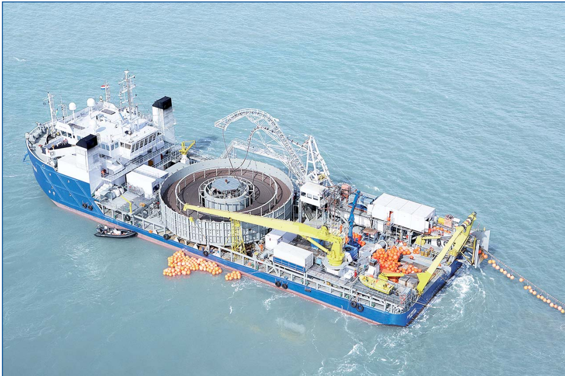
Abb. 3.24: Verlegung der 450-kV-HGÜ-Leitung namens BritNed, zwischen Isle of Grain in Kent (Groß Britannien) und Rotterdam (Niederlande) als Seekabel | Foto: ABB AG
