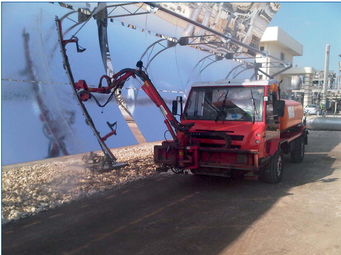
Abb. 3.4: Reinigung der Parabolrinnen des solarthermischen Kraftwerks Kuraymat, Ägypten Foto: Gerhard Hofmann, Agentur Zukunft
