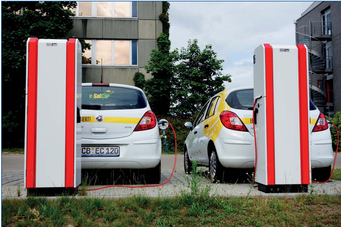
Abb. 3.37: Fahrzeuge des Projekts e-SolCar der BTU Cottbus-Senftenberg an den Ladesäulen – bei diesem Projekt wird auch die Nutzung von Fahrzeugbatterien als Speicher im Stromnetz untersucht Foto: Prof. Dr.-Ing. Harald Schwarz, BTU
