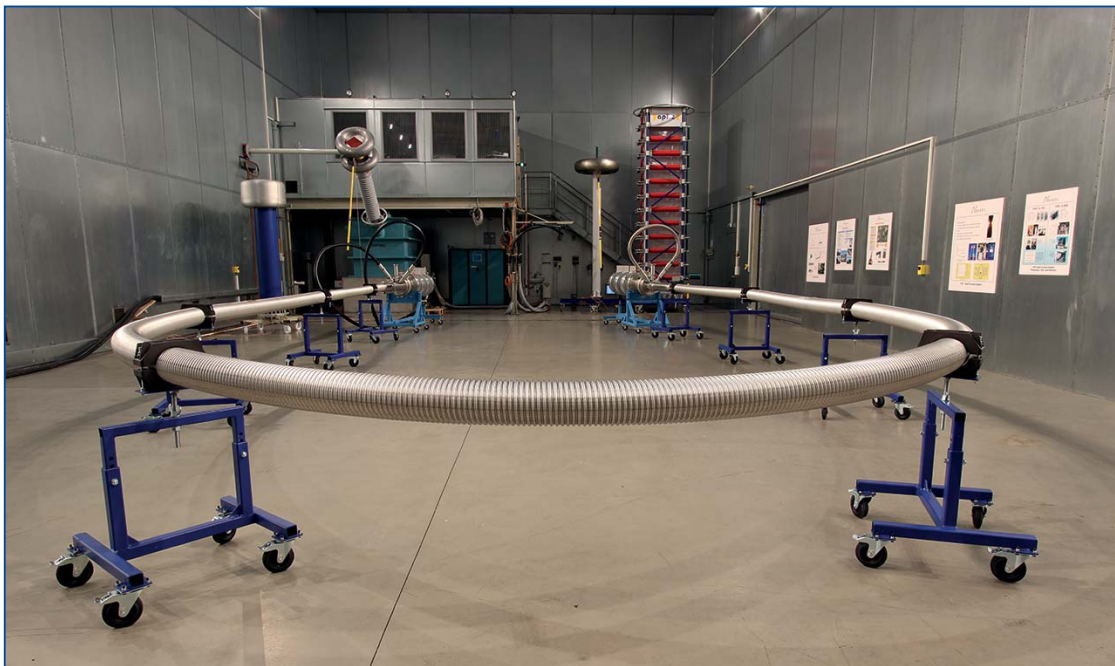
Abb. 3.27: Versuchsaufbau des Projekts „Ampacity“ | Foto: RWE Deutschland AG
